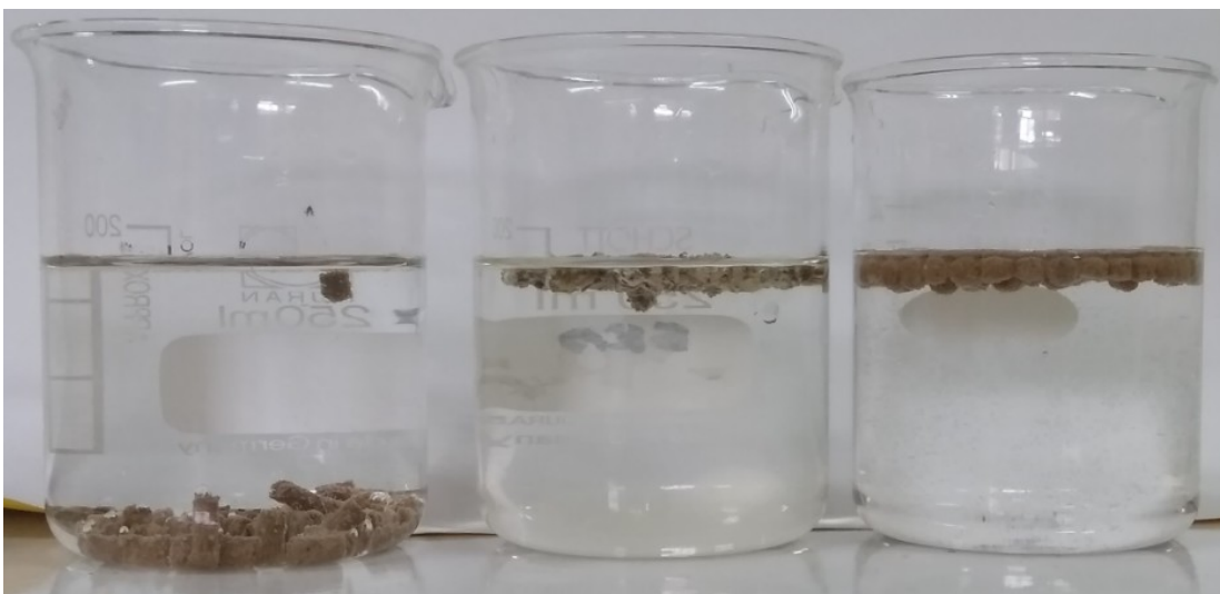
Gambar 3. Karakteristik daya apung dalam air dari pakan tenggelam komersial (kiri), pakan apung fermentasi (tengah), dan pakan apung komersial (kanan)
