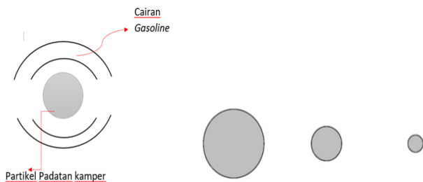
Gambar 2. Ilustrasi peluruhan padatan kamper di dalam cairan gasoline
