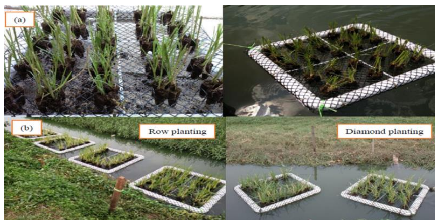
Gambar 3. Desain modifikasi eksperimen di lapangan floating treatment wetland (Kusin et al., 2018)
