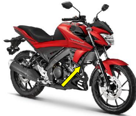
Gambar 3. Contoh sepeda motor 150cc dengan sistem pendingin tipe cairan (tanda panah) 1,2)
