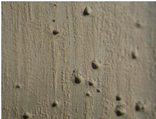
Gambar 7. Foto kondisi permukaan bagian dalam radiator terdapat kerak dari endapan air radiator.
