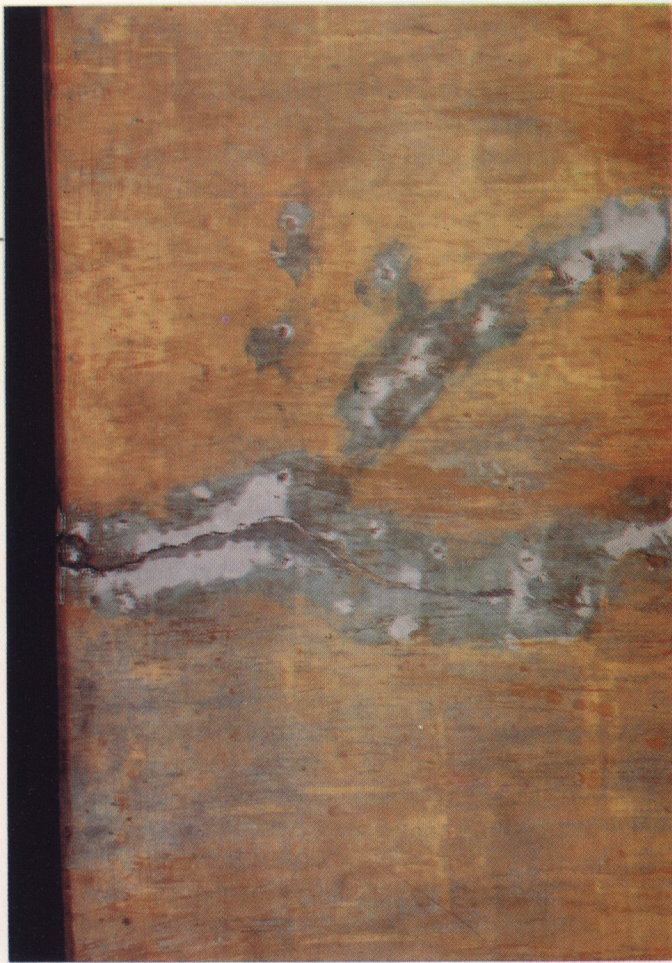
Foto 3 Salah Satu Retakan pada Lempengan Luar Lidah Api
