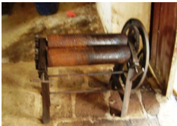
Foto 14. Alat untuk menggiling/mengepres karet di PT. Jasinga Estate (Sumber: Pusat Penelitian dan Pengembangan Arkeologi Nasional).
