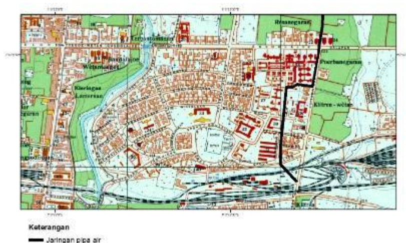
Gambar 2. Jalur pipa air di Kotabaru tahun 1925.
