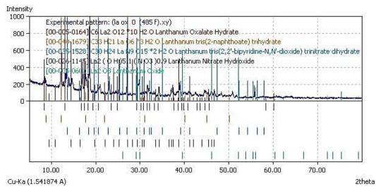
Gambar 2. Analisis difraksi sampel  $La_2(C_2O_4)_3$  sebelum kalsinasi dengan menggunakan program *Match*.
