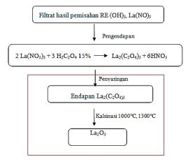
Gambar 1. Diagram alir proses pemurnian La<sub>2</sub>O<sub>3.</sub>
