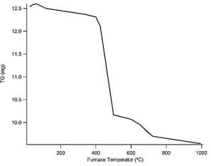
Gambar 5. Kurva TGA Pembentukan La<sub>2</sub>O<sub>3.</sub>
