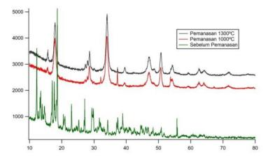
Gambar 3. Difraksi La<sub>2</sub>(C<sub>2</sub>O<sub>4</sub>)<sub>3</sub> sebelum dan setelah kalsinasi 1.000°C dan 1.300°C.
