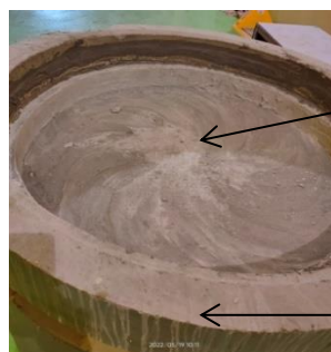
Gambar 2. Agregat beton hasil sementasi konsentrat
