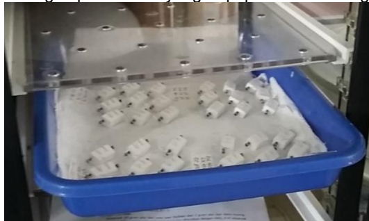
Gambar 4. Detektor CR-39 dikeringkan dalam desikator elektrik.
