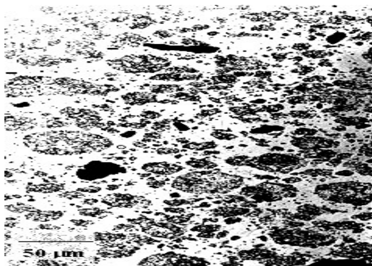
Gambar 6. Morfologi permukaan gel dengan SEM setelah dipanaskan 400°C, pembesaran 1000 X.
