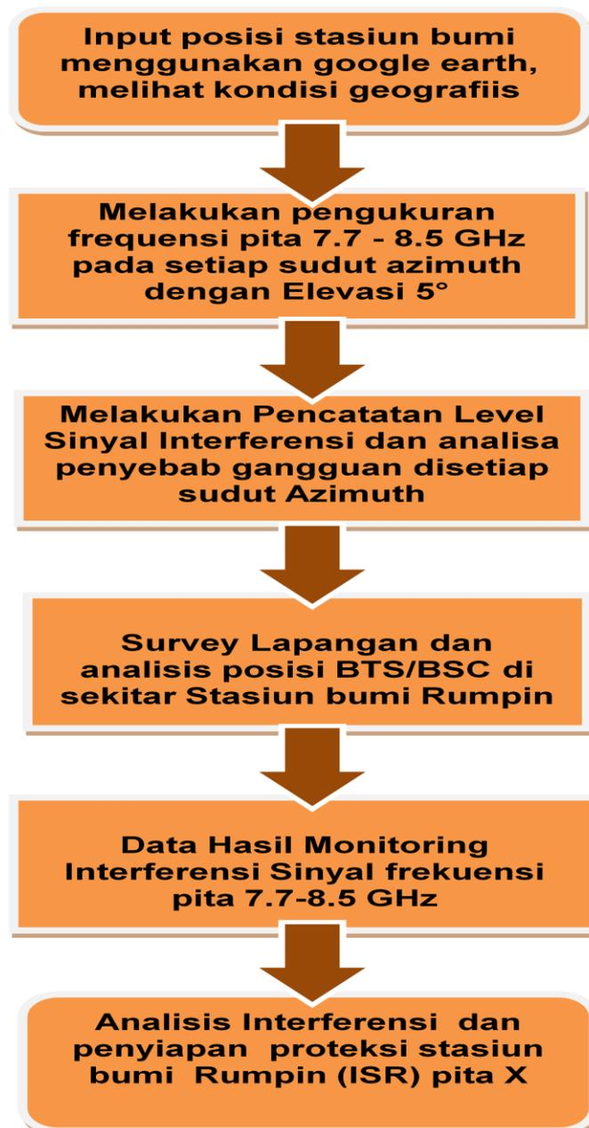
Gambar 4-1: Gambar flowchart Analisis Interferensi Frekuensi Pita 7.7-8.5 GHz
