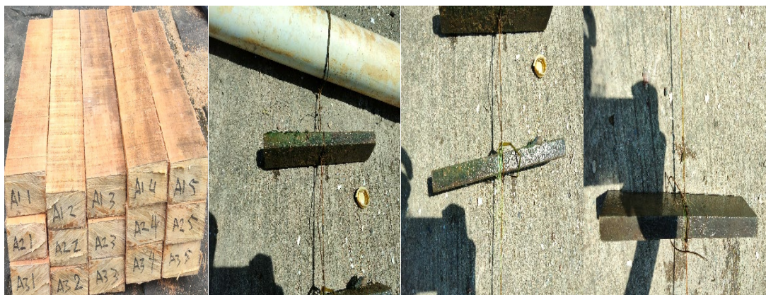
Gambar 5. Kondisi Sampel Kayu Bengkirai ( Shorea laevis ) (a) sebelum pengumpanan, (b) setelah pengumpanan selama 3 Bulan pada kedalaman 5 cm, (c) Pada kedalaman 25 cm, dan (d) Pada kedalaman 50 cm
