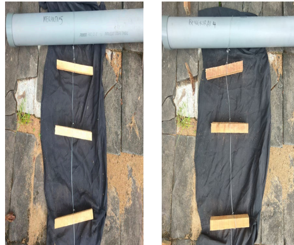
Gambar 1. Rangkaian Pengumpanan Contoh Uji (Modifikasi BSN 2014), (a). Kayu Meranti ( Shorea sp. ), (b). Kayu Bengkirai ( Shorea laevis )
