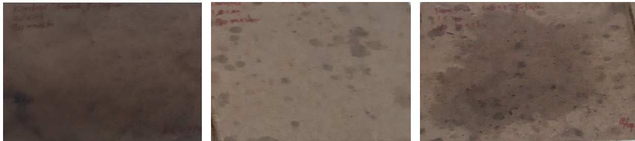
Gambar 1. Papan komposit sabut kelapa tanpa perekat (a) dan dengan perekat berbasis tanin dan lateks kadar 5% (b) dan 10% (c)
