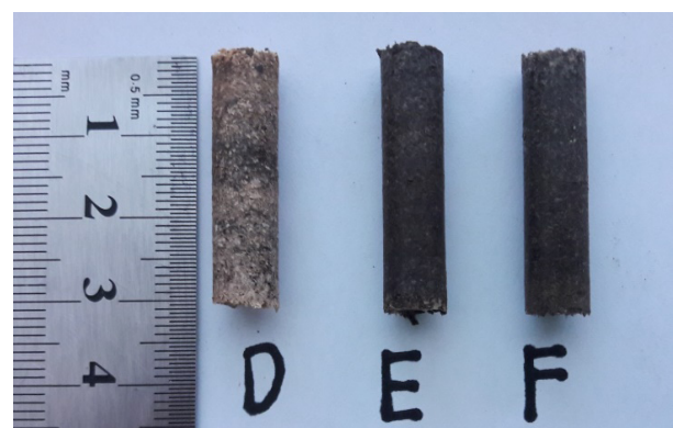
Gambar 4. Pelet kayu ketapang: D (kondisi kering udara), E (kadar air 15%), dan F (kadar air 20%)
