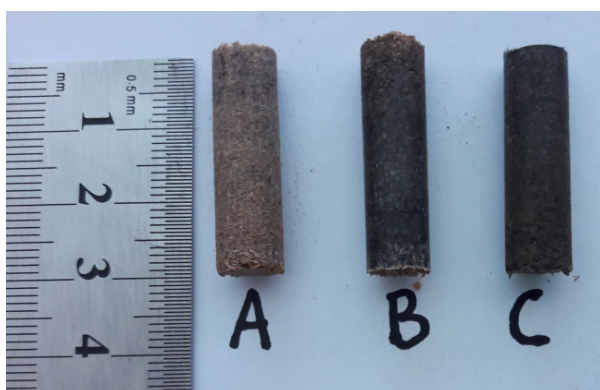
Gambar 3. Pelet kayu jabon: A (kondisi kering udara), B (kadar air 15%), dan C (kadar air 20%)
