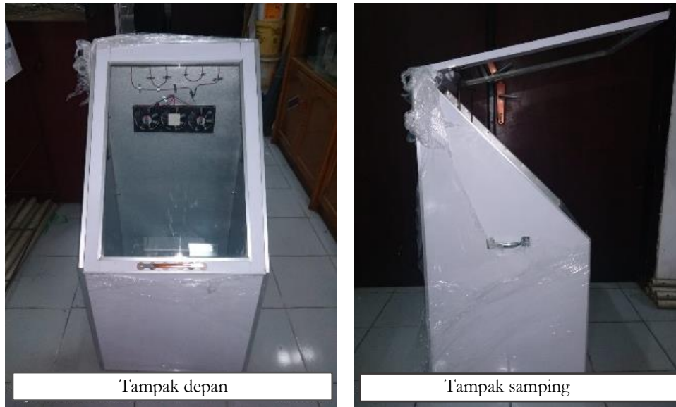
Gambar 3. Pengering kayu skala mikro dengan energi cahaya matahari Figure 3. Micro dryer with solar energy
