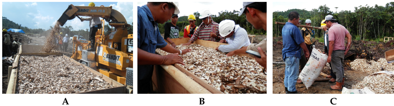
Gambar 4. Pengolahan limbah kayu menjadi chips dengan portable chipper Figure 4. Wood waste into chips with portable chippers
