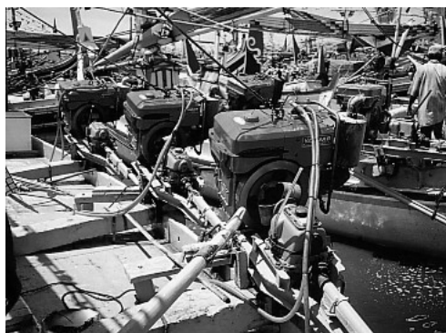
Gambar 1. Penempatan poros propeller pada bagian samping kapal
