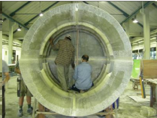
Gbr 21. Proses Penyambungan Sisi Dalam.
