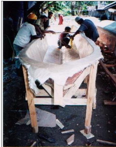
Gbr 40. Pesiapan Pemasangan Penegar.
