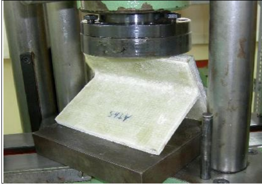
Gbr 16. Uji Sambungan fibreglass .
