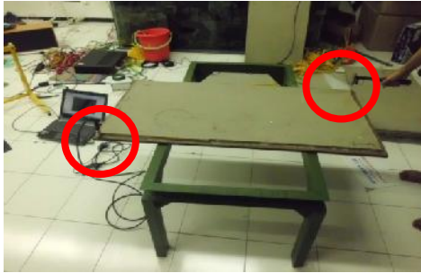
Gambar 7. Konfigurasi accelerometer dan martil impak di tiap ujung specimen
