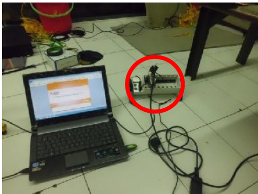
Gambar 8. Konfigurasi laptop dan NI cDAQ – 9178 serta software sound and vibration
