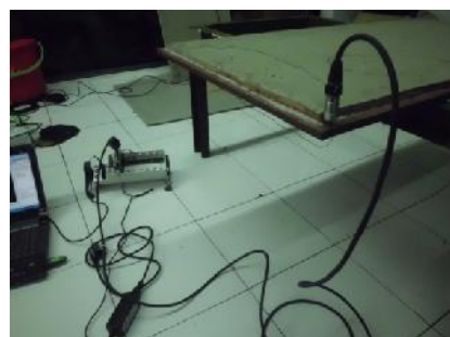
Gambar 6. Konfigurasi accelerometer di ujung specimen
