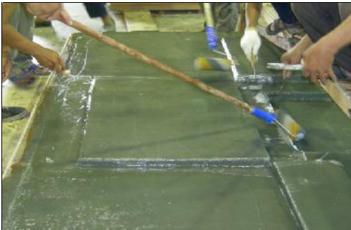
Gambar 4. Laminasi pelat FRP Dengan Hand Lay-Up
