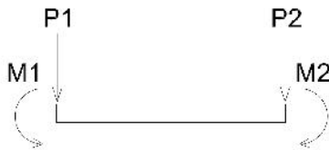
Gambar 2. Anggota struktur yang terkena beban p_x dan p_y dan momen m
