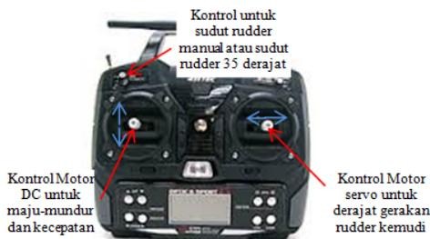
Gambar 2 Tuas-tuas pada *remote control* hitec yang digunakan sebagai kendali model kapal
