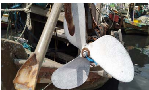
Gambar 2. Benda uji 2 diangkat/dikeluarkan dari perendaman air laut
