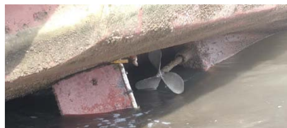
Gambar 3. Benda uji 1 tetap di rendam dalam air laut
