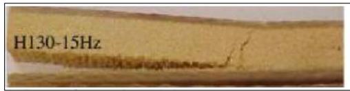
Gambar 2. Ilustrasi kerusakan *core* pada pelat *sandwich* (Palomba, et al., 2021)
