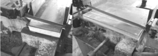
Gambar 8. Pemotongan sandwich panel dengan mesin Band SAW RF-812 N
