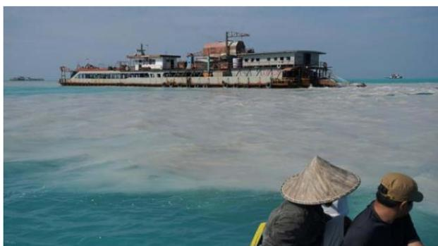
Gambar 1. Kapal Isap Produksi (KIP) timah yang beroperasi di perairan Bangka (Agustinus, 2018)
