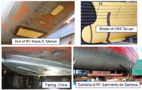
Gambar 2. Tipe dudukan MBES dan konsep distraksi aliran
