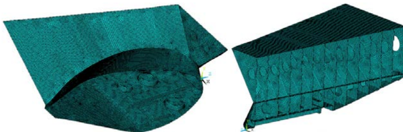
Gambar 8. Susunan mesh pada plat kulit luardan struktur bagian dalam
