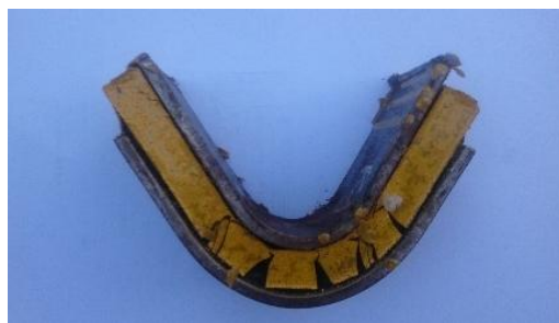
Gambar 8. Sandwich yang telah di uji
