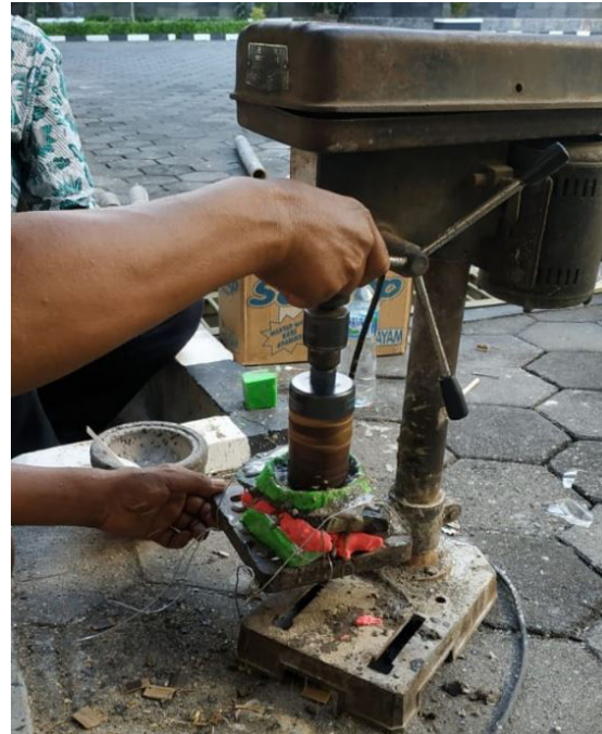
Gambar 4. Proses pengeboran dengan menggunakan mata bor bambu, bahan pengikis air dan pasir kuarsa (sumber : Dokumentasi Tim Penulis 2020)
