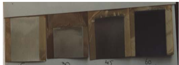
Gambar 10. Penampakan lapisan anodis hasil anodisasi keras pada temperatur 9 °C dengan penambahan 2 wt % asam oksalat
