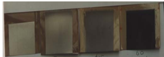
Gambar 9. Penampakan lapisan anodis hasil anodisasi keras pada temperatur 19 °C dengan penambahan 1 wt % asam oksalat
