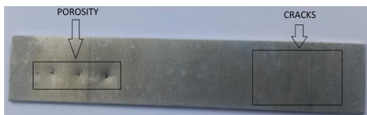
Gambar 1. Pelat elemen bakar dummy yang telah diberikan cacat artifisial.
