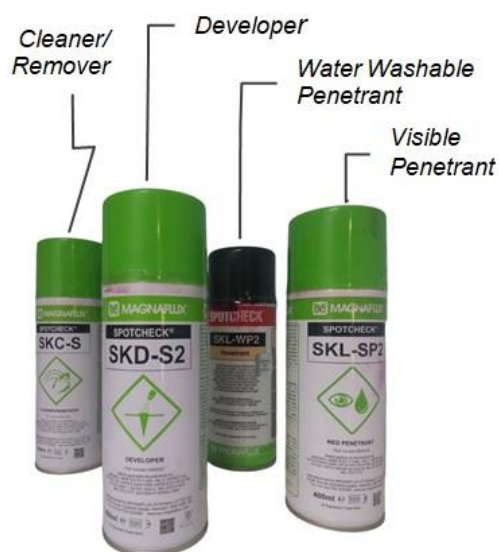
Gambar 2. Aerosol dan pelarut untuk simulasi penetrant test pada PEB dummy .
