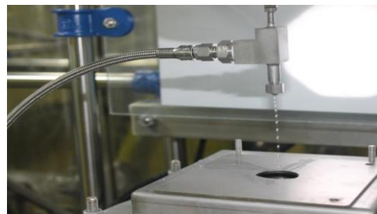
Gambar 7. Tetes sol keluaran nozzle penetes yang baik
