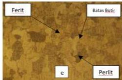
Gambar 5. Struktur mikro (a) sampel A, (b) sampel B, (c) sampel C, (d) sampel D, (e) sampel E.
