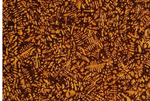
Gambar 1. Mikrostruktur paduan U-7Mo hasil proses peleburan
