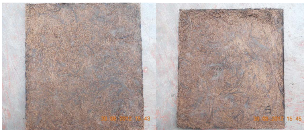
Gambar 2. Papan partikel dari TKKS dengan ukuran partikel 1-5 cm (kiri) dan papan partikel dari TKKS dengan ukuran partikel 6-10 cm (kanan).
