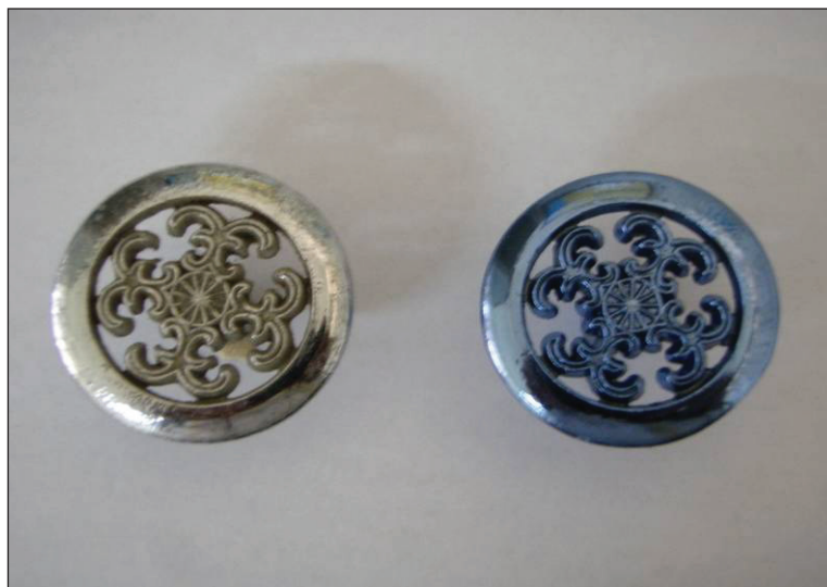
Gambar 3. Sampel sebelum dan sesudah dilakukan pelapisan organic electrocoating
